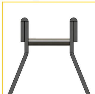
Massive Distanzstege im Wassereinfluss-Schlitz
