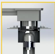
integrierte, zweiteilige Bodenabläufe DN 70 und DN 100 mit Klebeflansch oder Pressdichtungsflansch zum Anschluss der Abdichtung, Bodenabläufe mit herausnehmbarem Geruchsverschluss und Schmutzeimer, weitere Informationen siehe Rubrik Bodenabläufe
