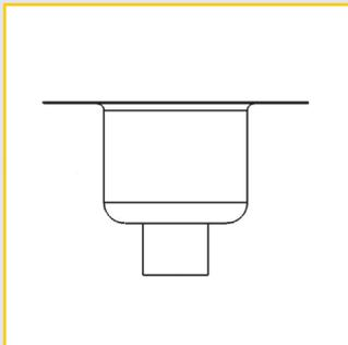
**Bodenabläufe DN 70 mit Klebeflansch**
