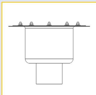
**Bodenabläufe DN 100 mit Pressdichtungsflansch**
