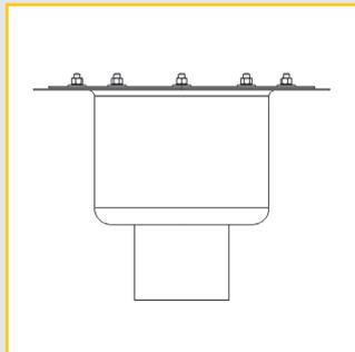
**Bodenabläufe DN 70 mit Pressdichtungsflansch**
