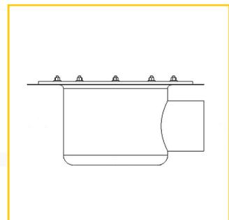
**Bodenabläufe DN 100 mit Pressdichtungsflansch**
