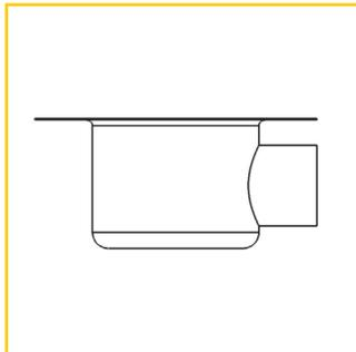
**Bodenabläufe DN 70 mit Klebeflansch**
