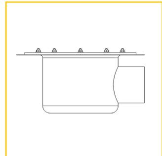
**Bodenabläufe DN 70 mit Pressdichtungsflansch**
